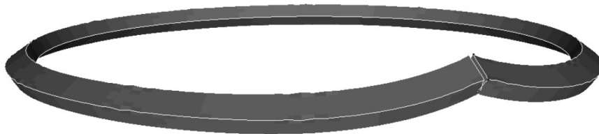
Abb. 2: Typisches Bewegungsverhalten eines Kolbenrings bei der eine stabile Lage an einer Nutflanke nicht erreicht wird. Abstützung auf beiden Nutflanken notwendig
