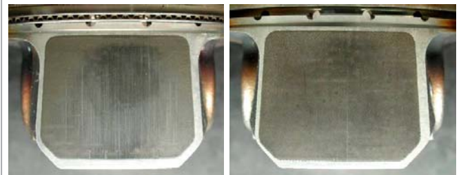
与竞争活塞 (左) 相比，发动机测试后，EcoTough 涂层活塞 (右) 的磨损明显更小。
